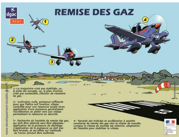
Remise des gaz
