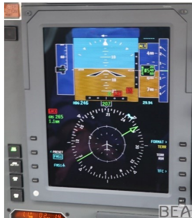
Figure 3 : PFD de gauche du N222NF lors de la mise sous tension de l'avion quelques jours après l'événement (Source : BEA)
