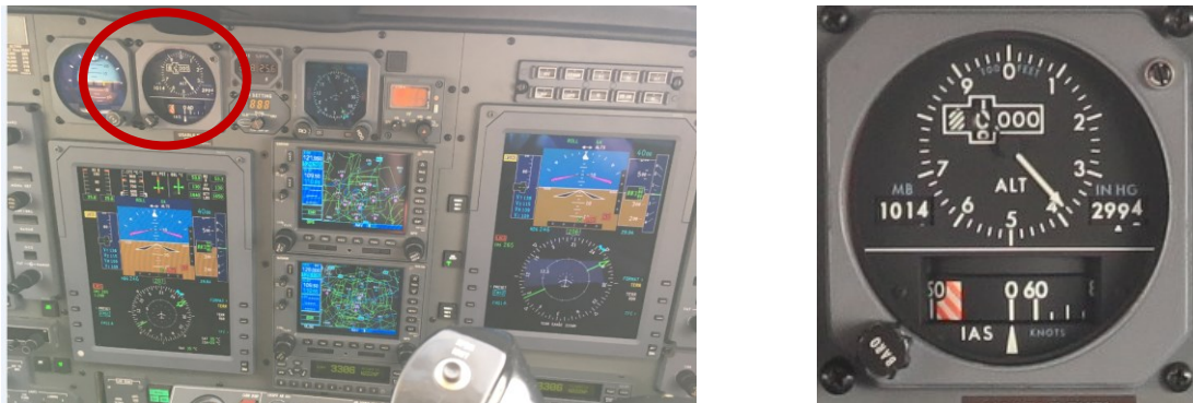
Figure 5 : altimètre et anémomètre de secours (source : BEA)
