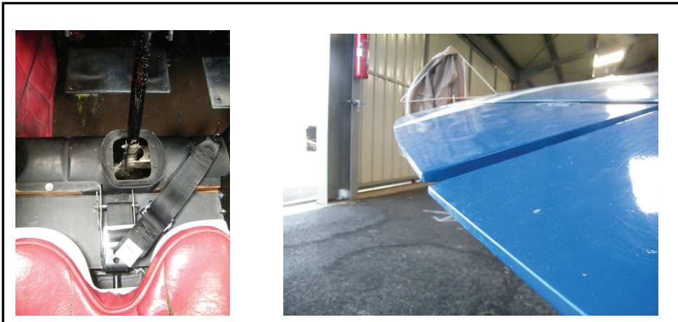
Position de l'aileron gauche avec manche place gauche dans l'axe du siège pilote sur CAP10 B
