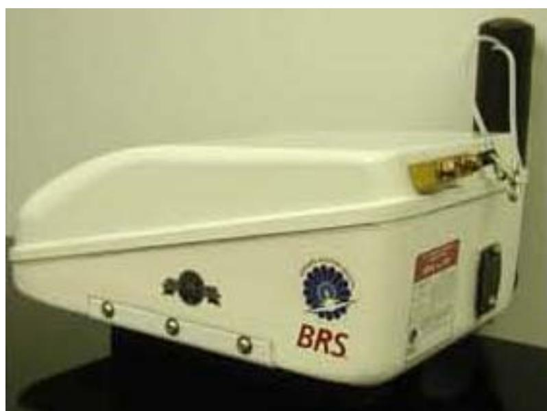
**Illustration 7:** Parachute emballé dans un container trapézoïdal
