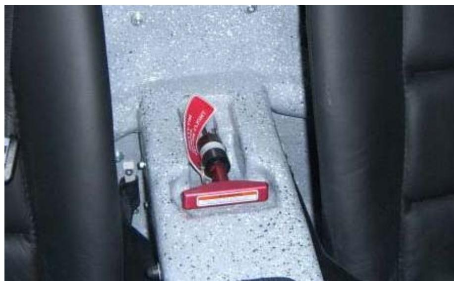
**Illustration 5:** Poignée permettant d'actionner le BPS
