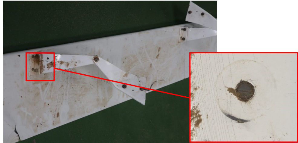
Figure 4 : potence du volet gauche et extrémité de vis de fixation de la bielle en place dans l'alésage (Source : BEA)
