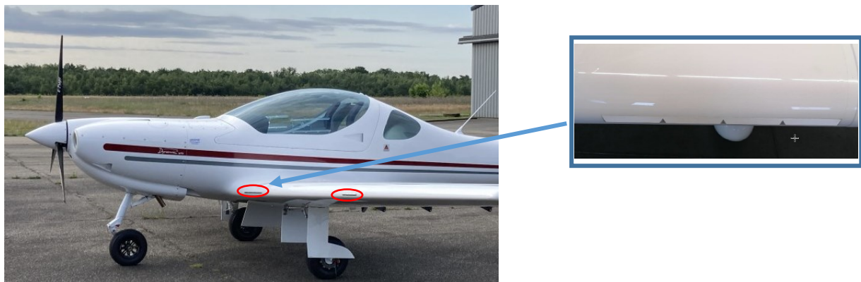
Figure 6 : stall-strips (entourées en rouge) sur un autre WT9 ULM (Source : Finesse Max, annotation BEA)
