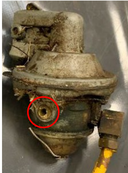
Cassure du raccord au droit de l'orifice de sortie de la pompe mécanique
