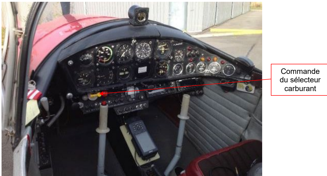
Figure 91 : commande du sélecteur carburant Source : Photo remise au BEA par l'ancien propriétaire de l'avion
