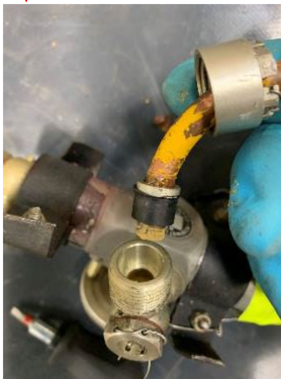
Figure 84 : exemple de raccord avec le joint en position et entier Source : BEA
