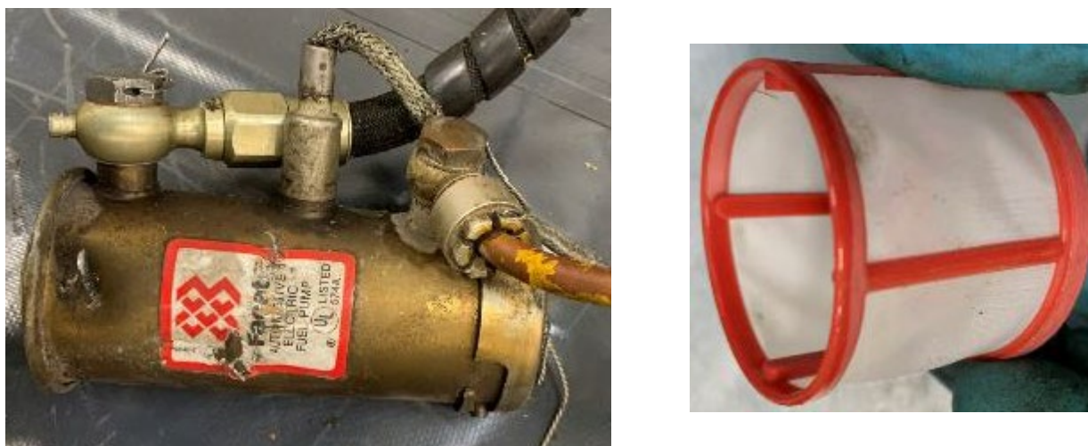
Figure 100 : pompe électrique Source : BEA
