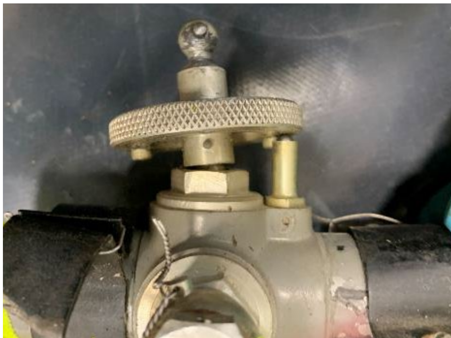
Figure 96 : axe du sélecteur déformé en flexion Source : BEA
