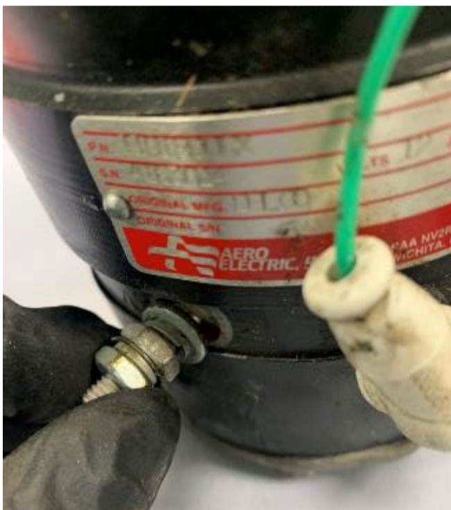
Endommagement du point de fixation de la sortie de puissance
