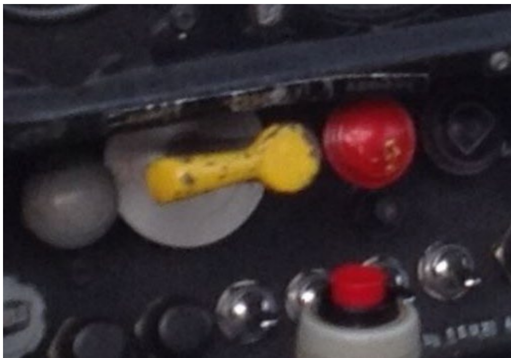
Figure 92 : détail de la commande du sélecteur carburant Source : Photo remise au BEA par l'ancien propriétaire de l'avion
