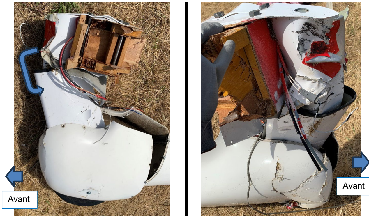
Figure 8 : train d'atterrissage droit (jambe de train déformé vers l'arrière)
