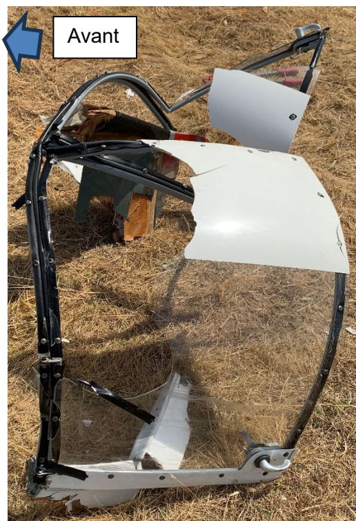
Figure 17 : déformation de la structure métallique de la verrière
