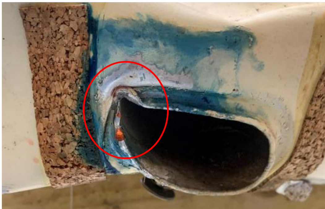
Figure 89 : fuite sur la partie arrière du réservoir
