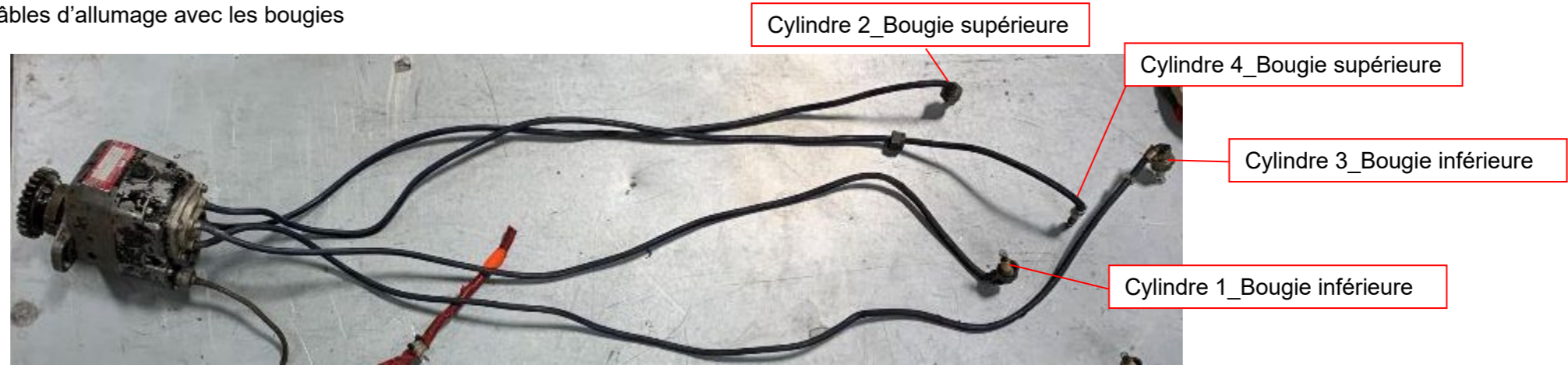
Figure 60 : identification des câbles d'allumage Source : BEA
