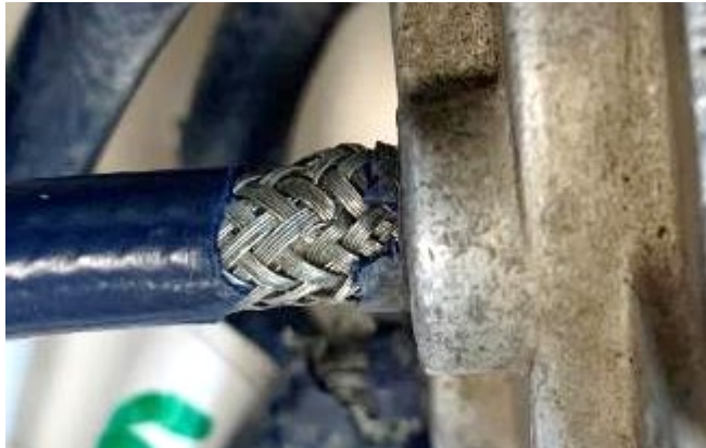
Figure 66 : câble d'allumage associé à la bougie supérieur du cylindre 4 Source : BEA
