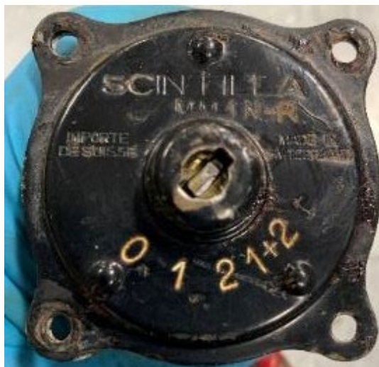
Figure 80 : sélecteur magnétos, avec la clé rompue, en position 0
