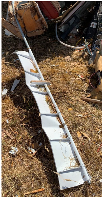
Figure 7 : aérofrein droit désolidarisé de l'aile droite Source : BEA
