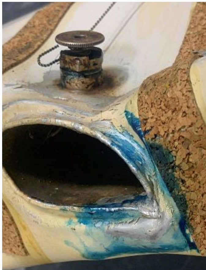
Figure 87 : teinte bleutée autour de la purge et sur sa partie arrière
