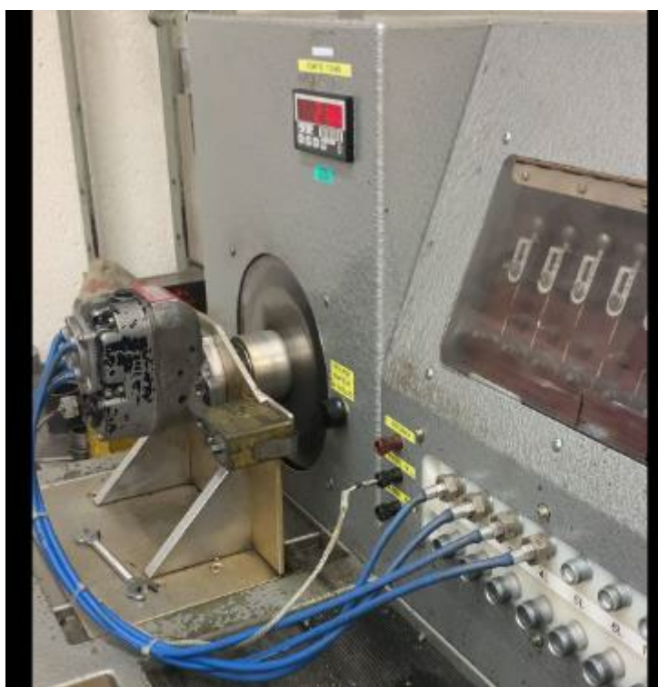
Figure 58 : magnéto testée sur un banc d'essai spécifique
