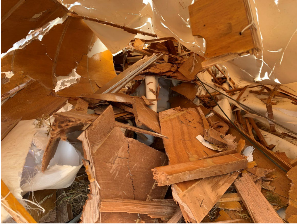
Figure 6 : structure interne détruite de l'aile droite Source : BEA
