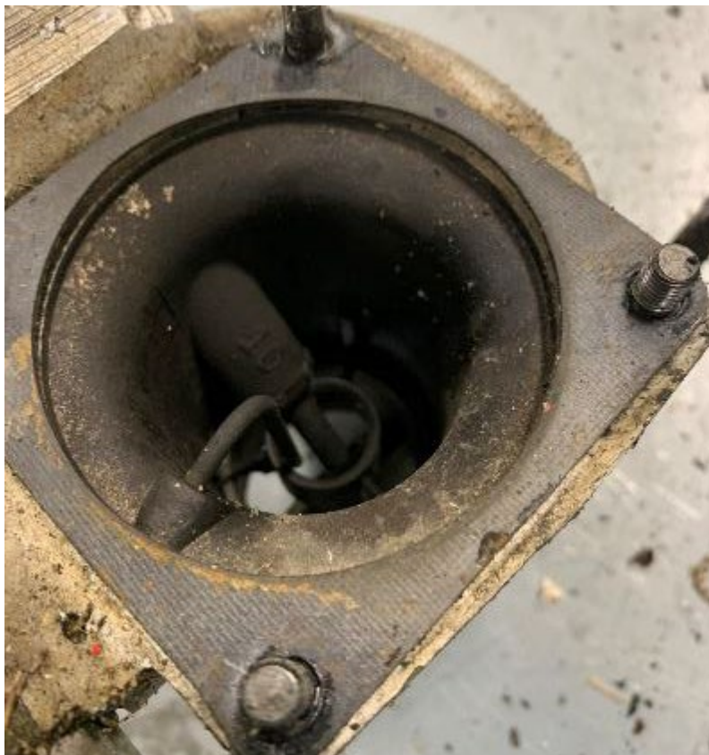
Figure 110 : présence significative de suie noire dans le canal du carburateur
