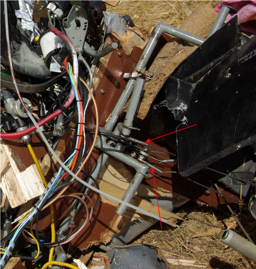
Figure 21 : câbles de commande associés aux palonniers Source : BEA
