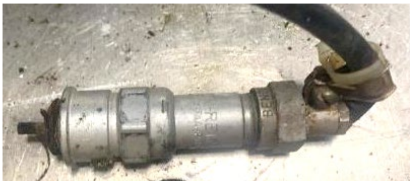
Figure 44 : bougie supérieure arrachée de la culasse du cylindre 3
