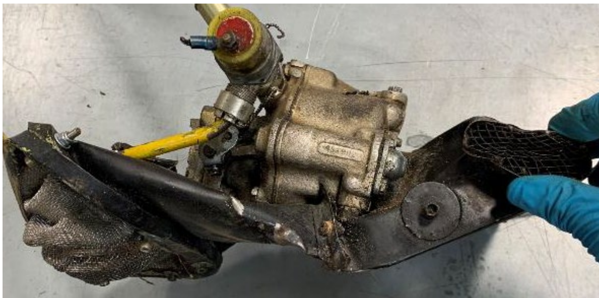
Figure 104 : Boîte à air écrasée contre le carburateur
