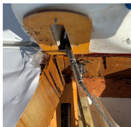
Câble attaché à l'extrados de l'aileron
