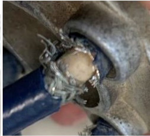
Figure 66 : câble d'allumage associé à la bougie supérieur du cylindre 4 Source : BEA
