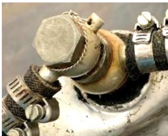
Raccord de sortie du réservoir
