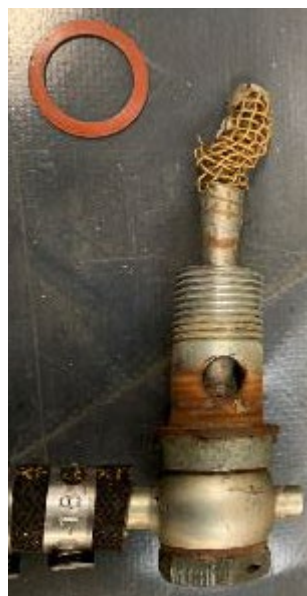
Crépine située au droit du raccord de sortie
