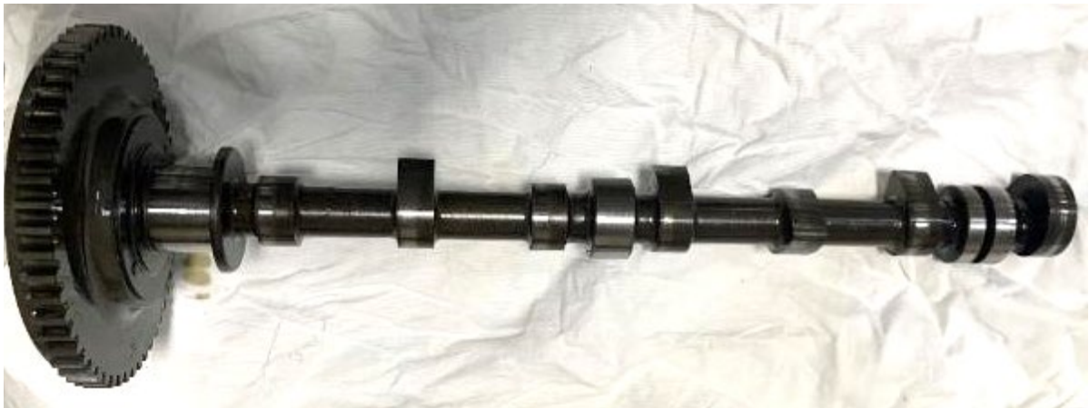
Figure 55 : arbre à cames Source : BEA
