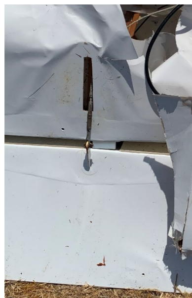
Câble attaché à l'intrados de l'aileron
