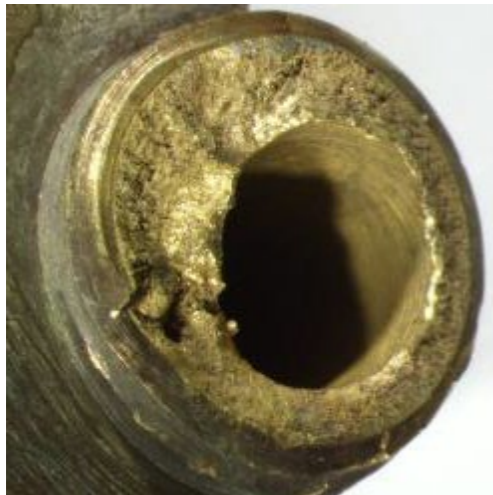
Détail de la cassure côté raccord
