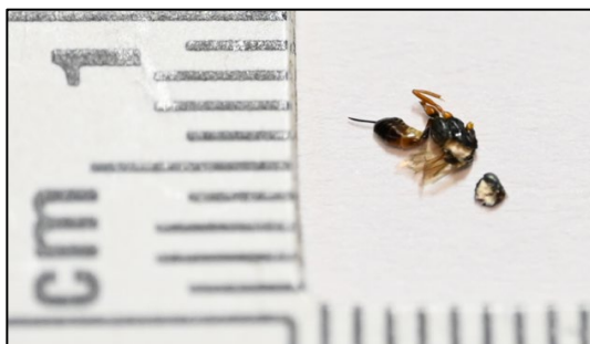
Figure 3 : Détail de l'insecte retrouvé dans le gicleur principal du carburateur droit
