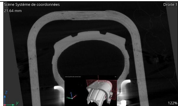
Figure 7 : délamination observée en tomographie (Source : BEA)
