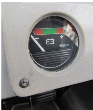
Figure 3 : voltmètre (Source : BEA)
