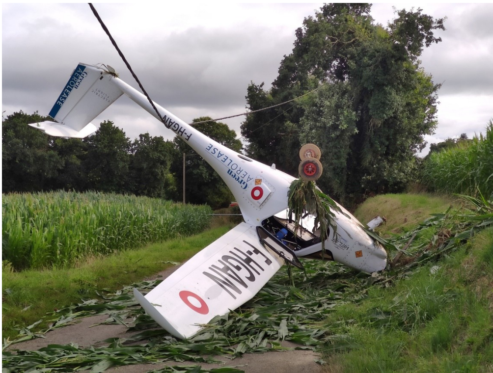
Figure 2 : F-GHAN immobilisé par une ligne électrique à l'issue de l'accident (Source : aéroclub de Morlaix)
