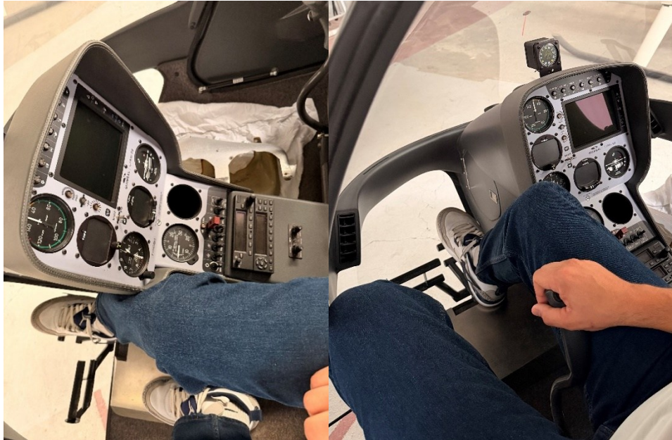
Figure 8 : limitation du débattement de la commande de pas cyclique avec un occupant de grande taille / forte corpulence en place gauche (Source : BEA)
