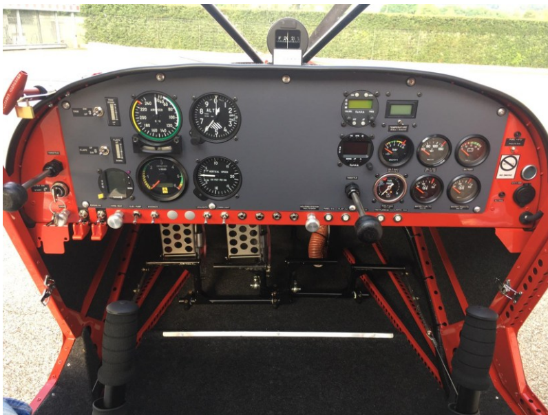
Figure 8 : panneau instrumental du 3A-ULM à sa livraison (Source : ICP)
