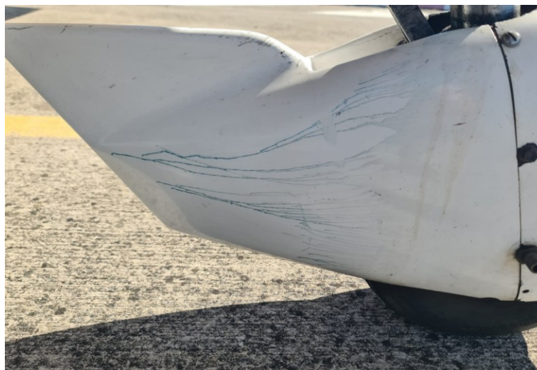
Figure 6 : carénage du train avant du F-GAIB après les essais au sol du 10 août 2024 (Source : Propriétaire de l'avion)
